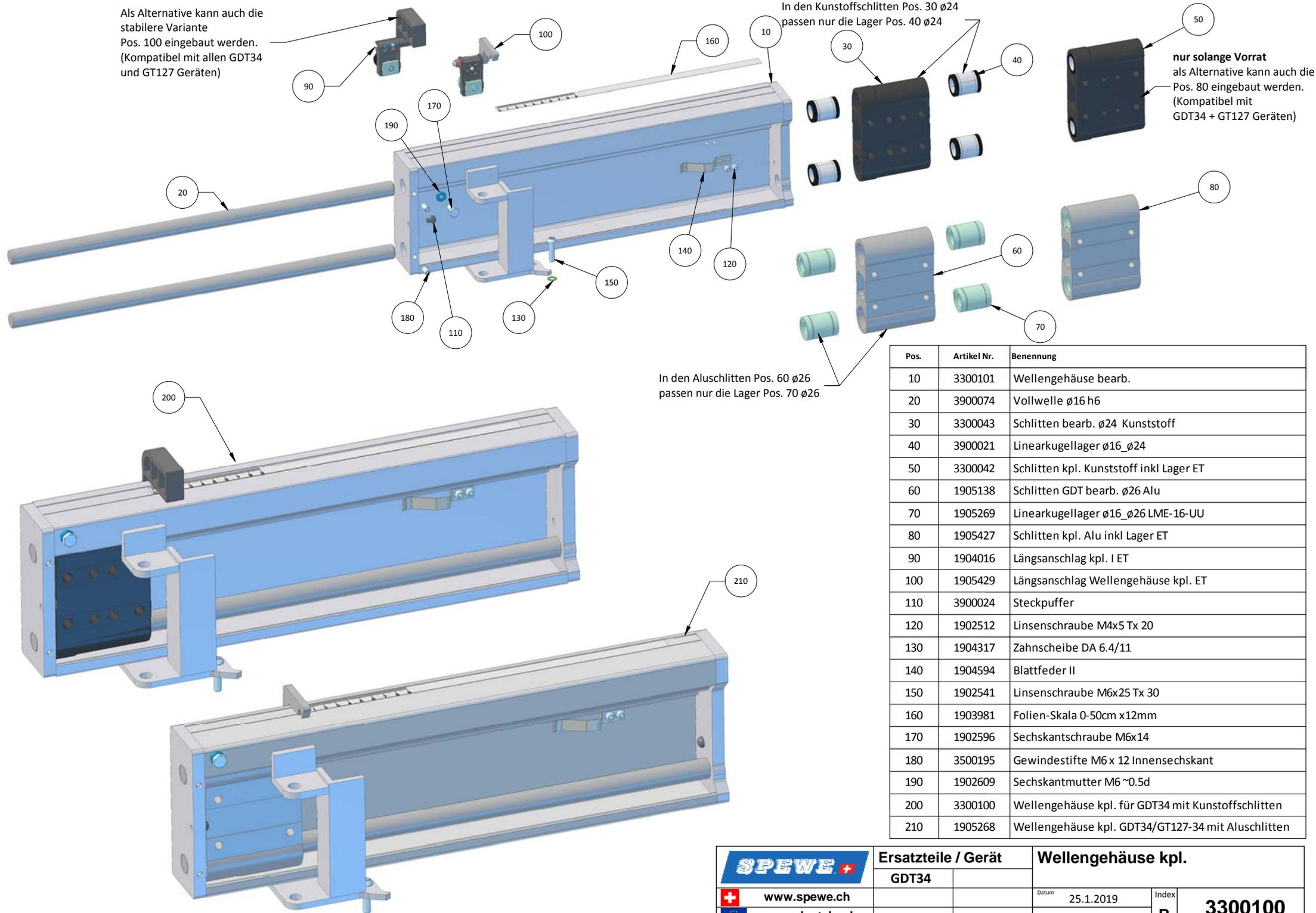
In den Kunststoffschlitten Pos. 30  $\varnothing$ 24 passen nur die Lager Pos. 40  $\varnothing$ 24
